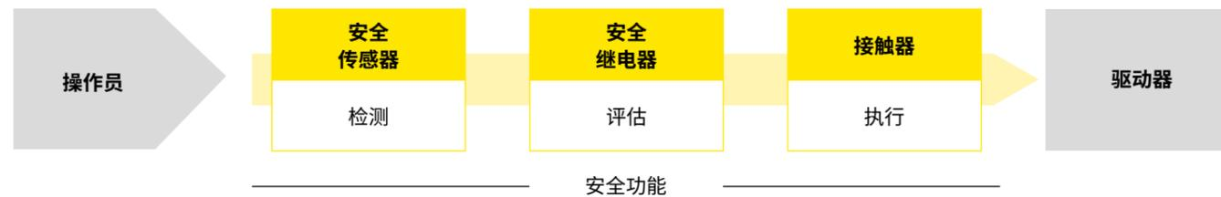
安全功能通常由人为触发,例如在打开或翻转门时中断安全光幕或激活安全开关。安全继电器可检测传感器发出的信号,并通过其常开触点断开接触器的供电电压,而接触器将会断开驱动器的电源。
